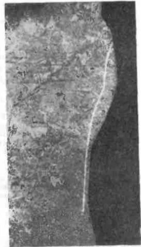
Рис. 153. Микроструктура стыка труб из стали 20, сваренных оплавлением с угольным брикетом, после разрушения при испытании на ударный изгиб; ×100
