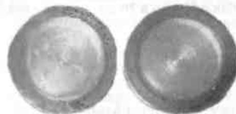
Рис. 159. Торцы предварительно окисленных образцов из стали X18H9T с выточкой после вакуумного отжига при 1000^\circ \text{C} в течение 15 мин
