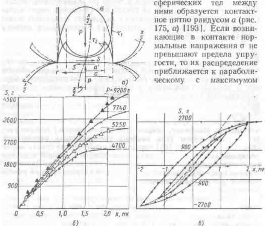
Рис. 175. Предварительное смещение x при трении покоя [193]:
