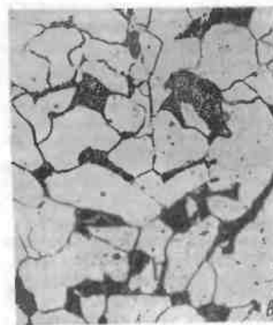
Рис. 163. Микроструктура зоны соединения при диффузионно-вакуумной сварке стали Ст. 3 с кратковременным нагревом; \times 500 : а — после сварки; б и в — после нормализации
