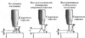
Рис. 6.4. Саморегулирование длины сварочной дуги
