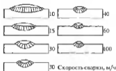
Рис. 7.14. Влияние скорости сварки на форму сварного шва (цифры означают скорость сварки в метрах в час)
