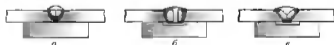
Рис. 7.27. Сварка на медной подкладке: а — без зазора и без разделки кромок, б — с зазором без разделки кромок, в — без зазора с разделкой кромок
