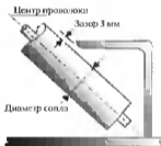
Рис. 7.21. Сварка углового шва при ограниченном доступе к стыку
