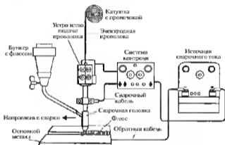
Рис. 7.2. Схема установки для сварки под флюсом
