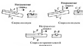
Рис. 7.16. Влияние наклона изделия на форму сварного шва и глубину проплавления
