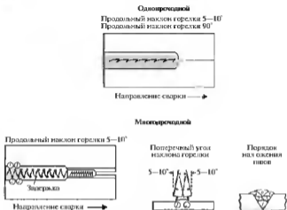
Рис. 6.34. Манипулирование горелкой при выполнении стыкового шва в нижнем положении
