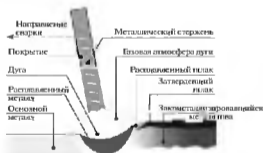
Рис. 2.1. Схема процесса ручной дуговой сварки покрытыми электродами
