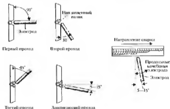
Рис. 2.33. Положение электрода при сварке стыкового соединения со скосом кромок в горизонтальном положении узкими валиками без поперечных колебаний электрода
