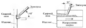
Рис. 2.31. Положение электрода при сварке таврового соединения многопроходным швом в нижнем положении с применением поперечных колебаний электрода
