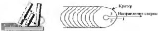
Рис. 2.6. Повторное зажигание сварочной дуги. 1 — возбуждение дуги, 2 — перенос дуги на противоположную кромку кратера, 3 — перенос дуги на переднюю кромку кратера
