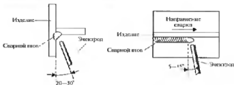
Рис. 2.47. Положение электрода при сварке таврового соединения в потолочном положении однопроходным угловым швом
