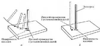
Рис. 2.4. Методы зажигания дуги: а — боковым движением, б — касанием электрода
